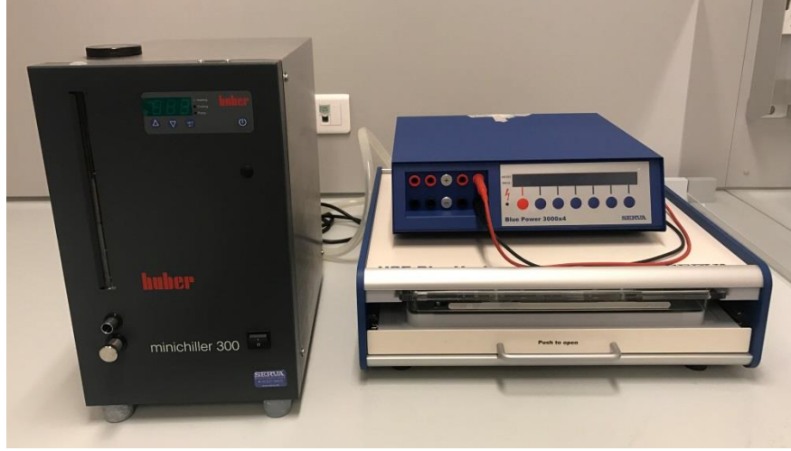
Şekil 5. HPE (High Performance Electrophoresis) BlueHorizon yatay elektroforez sistemi
