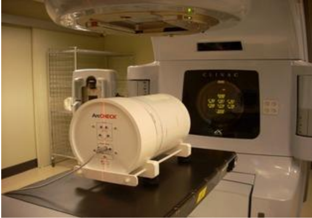
Şekil 19. Arccheck'in set-up sonrası görünümü
