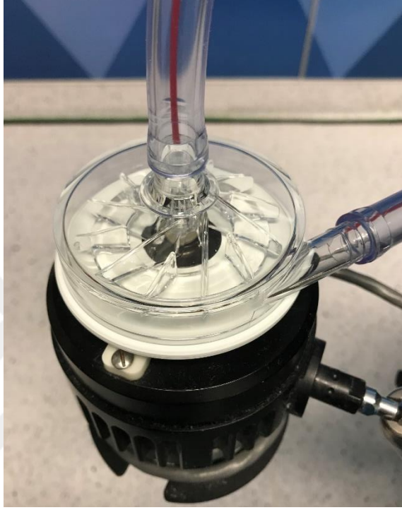
Resim 2.3. Santrifüj Pompa Başlığı ve Motor Sürücüsü
