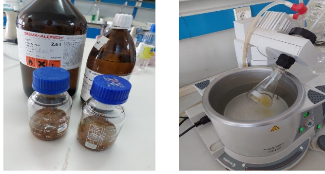
Resim 7. Atıştırmalık barların yağlarının n-hekzan ve dietil eter ile ekstrate edilmesi
