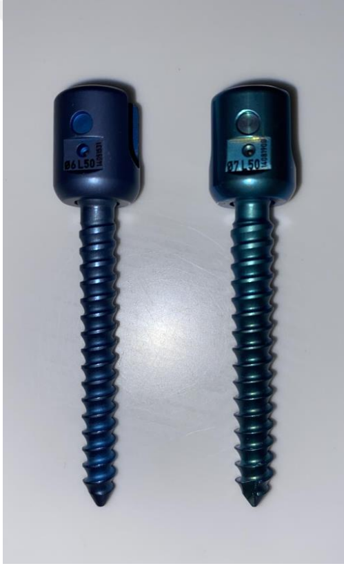
Resim 38. Çalışmada kullanılan 6 mm (sol) ve 7 mm (sağ) çaplarındaki tam yivli kortikal pedikül vidaları
