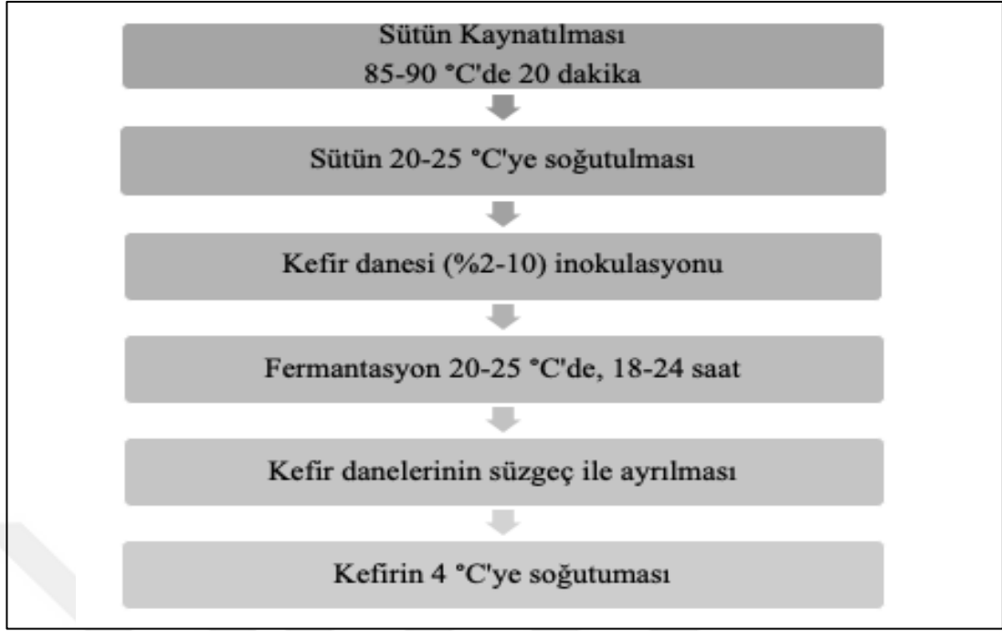
Şekil 2. Kefirin geleneksel üretim proses şeması (59)
