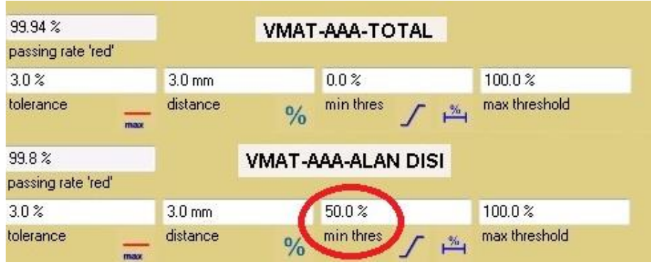
Şekil 4.13: VMAT-AAA Hesap Algoritmasının Tüm Plan ve Alan Dışı Doz Değerlendirmesi
