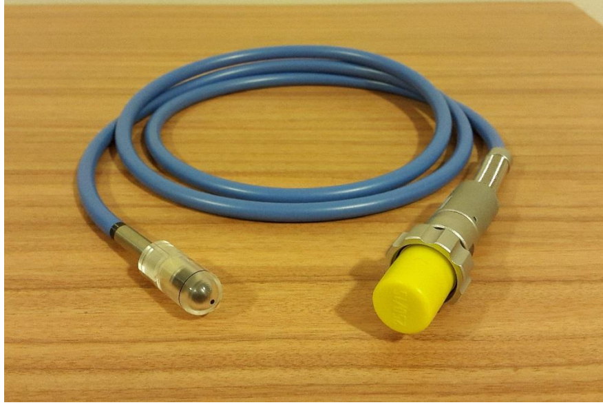
Şekil 3.8: PTW 31010 SemiFlex İyon Odası
