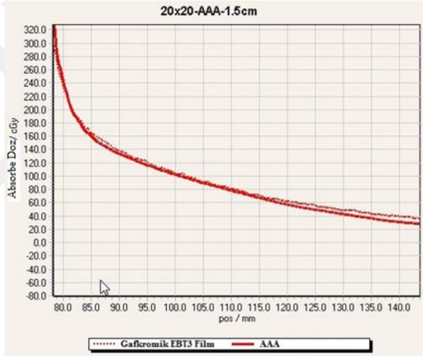
Şekil 4.7a: 20x20 cm 2 , 1,5 cm Derinlikte AAA'nın Hesapladığı Alan Dışı Doz Grafiği
