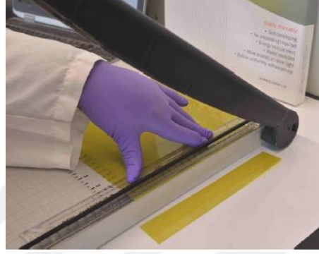
Şekil 3.2. Gafkromik EBT3 filmin istenilen şekillerde kesilmesi.
