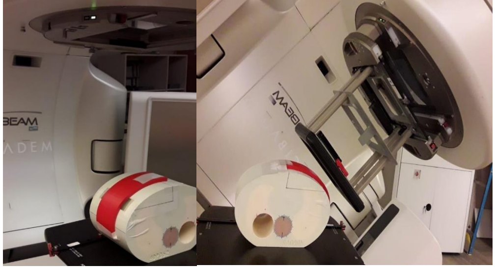
Resim 3.7. Foton ve elektron enerjilerinde gafkromik filmlerin ışınlanması.
