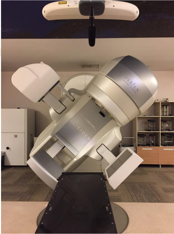
Şekil 3.1: Varian Cone-beam CT Simülör
