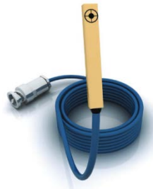
Resim - 5: Sun Nuclear EDGE diyot detektör
