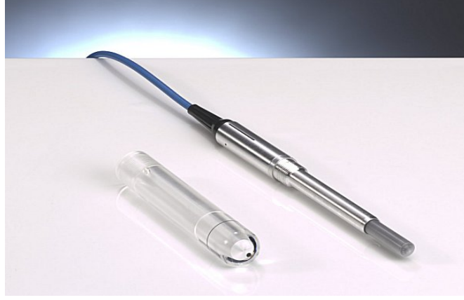
Resim - 1: PTW Farmer iyon odası detektörü
